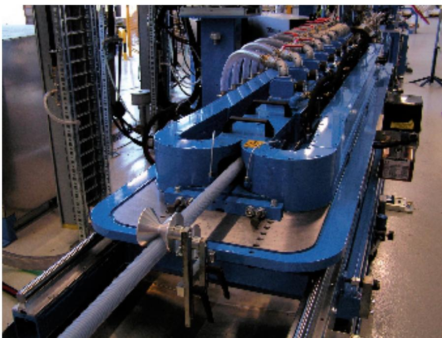
Extrusion d'un tube de protection en ligne autour d'une tube multicouche chez Geberit Fabrication SA.
