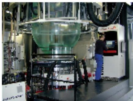
*L'extrusion-gonflage est une technique particulièrement spectaculaire d'extrusion qu'utilise Collano Services Extrusion AG pour la production de films adhésifs.*
